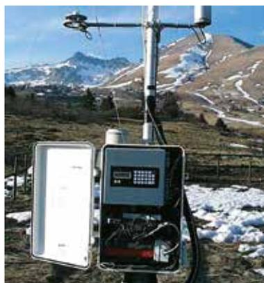
igrometro e termometro digitale per la misura della temperatura dell'aria e della neve.
