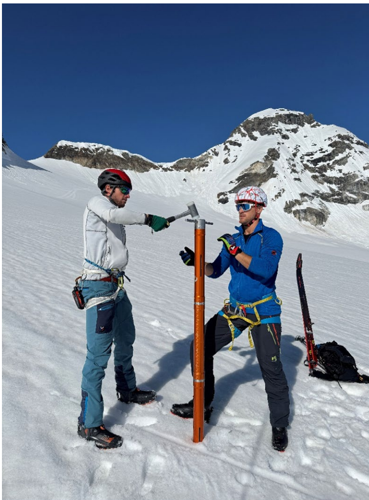
Immagine 3 - Operazioni di carotaggio del manto nevoso tramite il carotatore Valtecne per la valutazione dello SWE - Ghiacciaio dello Scalino
