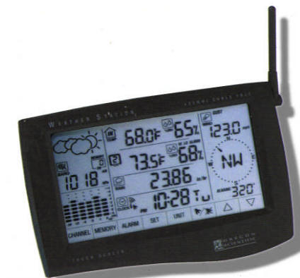
Fig. F.2.2.3.2.1 – Unità centrale di acquisizione dati di una stazione meteorologica a basso costo.
