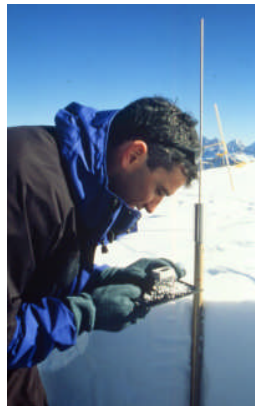
Fig. F.1.16.4.1.1 – Modalità di raccolta del campione di neve con la tavoletta cristallometrica per l'osservazione.
