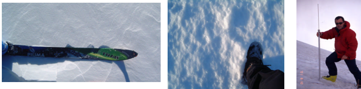
Fig. F.1.11.4.1 – Diversi metodi empirici impiegati per la misura della penetrabilità della neve: a) penetrazione dello sci; b) penetrazione del piede; c) penetrazione della sonda.
