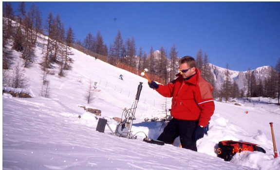
Fig. F.1.14.4.2.2 – Modalità di utilizzo del penetrometro Pandalp: la sonda viene battuta nel manto nevoso con un apposito martello.
