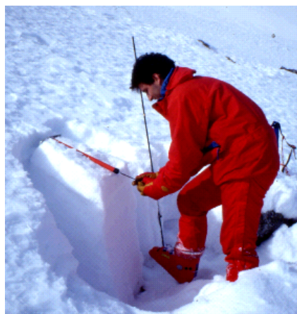
Fig. F.3.4.8.2 – Esecuzione del test della pala mediante una pala a manico pieghevole con dinamometro.
