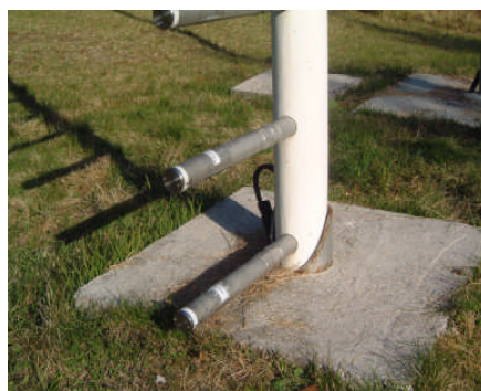
Fig. F.1.10.4.4.1 – Particolare di una termosonda utilizzata sulle stazioni nivometeorologiche automatiche per la misura delle temperature della neve; l'elemento sensibile inferiore viene fatto coincidere (per quanto possibile) con la superficie del terreno.
