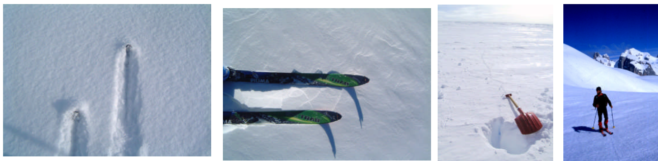
Fig. F.1.13.4.1 – Alcune tipologie di strato superficiale: a) strato a debole coesione di neve asciutta; b) crosta da vento non portante di neve asciutta; c) crosta da vento portante di neve asciutta (la foto è stata scattata sulla calotta antartica); d) crosta da fusione e rigelo portante di neve asciutta.
