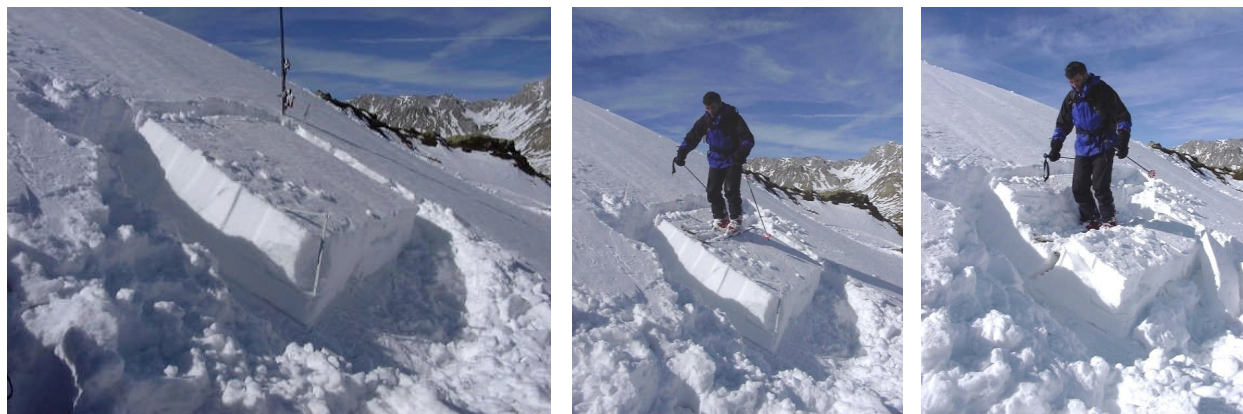
Fig. F.3.4.10.1.2 – Test del blocco di slittamento: a) blocco di neve su cui effettuare il test (inizio del test); b) corretta posizione di caricamento del blocco; c) rottura del blocco nello strato debole (fine del test).
