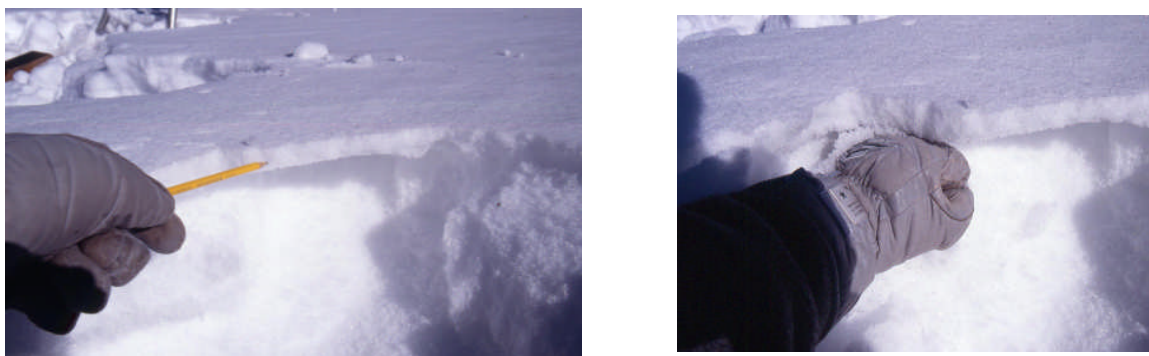
Fig. F.1.14.4.3.1 – Esempio di determinazione della durezza della neve mediante il test della mano: a) lo strato superficiale, costituito da una crosta da fusione e rigelo, si lascia penetrare esercitando una pressione con una matita (durezza alta); b) lo strato sottostante, di neve a debole coesione, si lascia penetrare esercitando una pressione con un pugno (durezza molto bassa).
