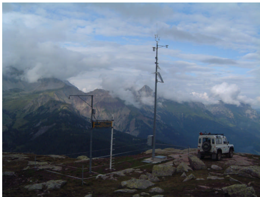
Fig. F.2.3.3.1.2 – Recinzione mobile leggera realizzata con filo elettrico per proteggere una stazione nivometeorologica automatica dagli animali al pascolo durante il periodo estivo (Cima Predazzo, Dolomiti meridionali, Provincia di Belluno).
