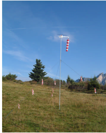
Fig. F.1.5.4.1- Velocità e direzione del vento possono essere stimate mediante l'ausilio di una manica a vento.
