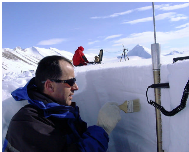
Fig. F.3.3.6.1 – L'identificazione dei vari strati (che può essere fatta con l'ausilio di un pennello) è la prima operazione da effettuare nell'analisi stratigrafica.
