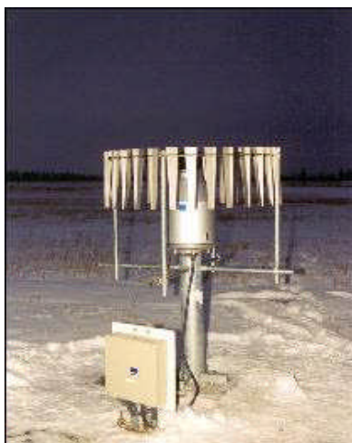
Fig. F.2.3.8.1 – Pluviometro totalizzatore non riscaldato GEONOR per la misura della precipitazione nevosa: lo scioglimento della precipitazione nevosa avviene mediante una soluzione antigelo mentre il sistema di misura della precipitazione (a filo vibrante) è senza parti meccaniche in movimento per evitare i problemi dovuti al gelo; da notare la barriera frangivento protettiva per limitare gli effetti del trasporto della precipitazione nevosa ad opera del vento in prossimità della bocca del pluviometro.
