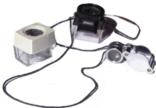
Fig. F.1.16.4.1 – Diversi tipi di lenti d'ingrandimento utilizzate per il riconoscimento delle forme e dimensioni dei grani.
