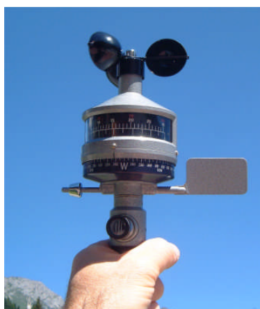
Fig. F.1.5.4.3.1- Anemometro a mano.
