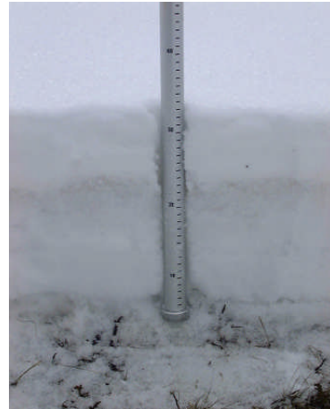
Fig. F.1.19.4.1 – Modalità di misura dello spessore degli strati: a) impiego di un doppio metro; b) impiego di un'asta graduata (nella fattispecie il primo elemento tubolare della sonda a percussione).
