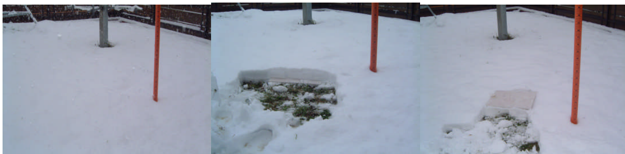
Fig. F.1.8.4.1.2- Sequenza delle operazioni per la misura dell'altezza di neve fresca: a) una palina di segnalazione indica nell'area della stazione, la posizione della tavoletta da neve; b) viene liberato un profilo della neve fresca fino alla tavoletta e viene eseguita la misura; c) a misura eseguita la tavoletta da neve viene riposizionata sulla superficie del manto nevoso.
