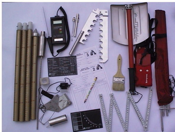
Fig. F.3.3.5.1 – Strumentazione portatile necessaria per l'esecuzione di un profilo della neve.
