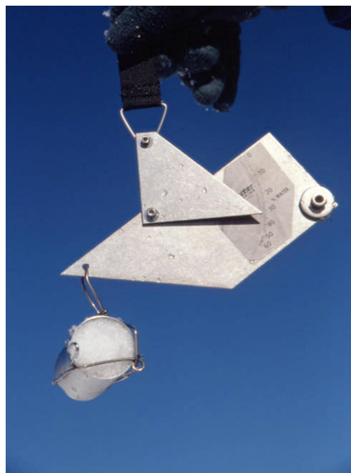
Fig. F.3.2.5.1 – Due degli strumenti portatili necessari per l'esecuzione del rilievo nivometeorologico giornaliero: a) lente d'ingrandimento; b) tubo carotatore con bilancia a stadera.
