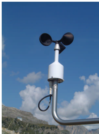
Fig. F.1.5.4.4.1- Sensore della velocità del vento a coppe rotanti.
