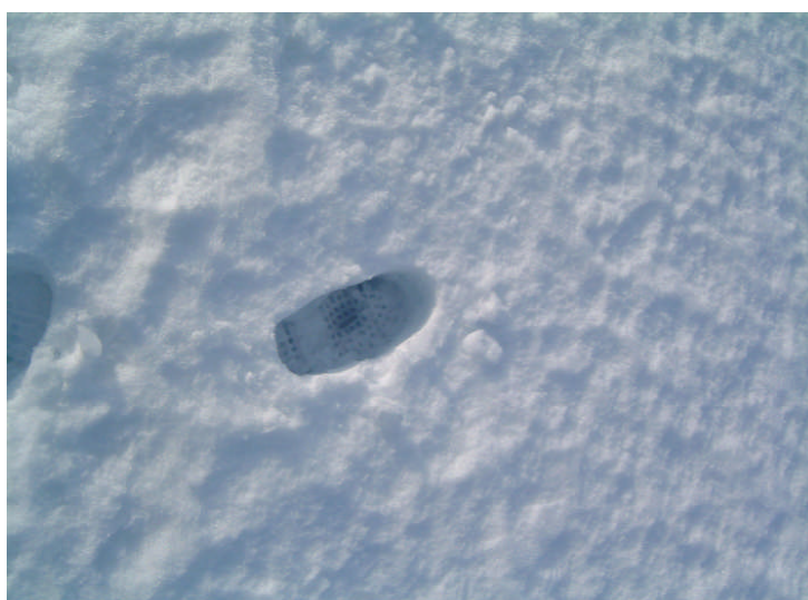
Fig. F.1.11.4.2 – Indipendentemente dall'oggetto impiegato, la penetrabilità della neve è data dalla profondità di penetrazione (in questo caso dalla profondità dell'impronta).
