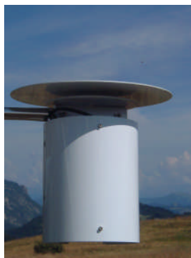
Fig. F.1.6.4.4.1- Termometro elettrico con protezione autoventilante collegato ad una stazione automatica.
