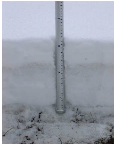
Fig. F.3.3.5.2 – Se il profilo del manto nevoso risulta in ombra vengono limitati gli effetti dell'irraggiamento sul manto nevoso nel lasso di tempo necessario per l'esecuzione delle misure e delle osservazioni.
