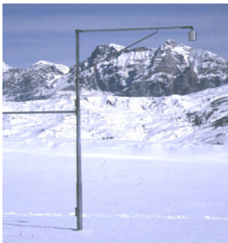
Fig. F.1.7.4.3.1- Nivometro ad ultrasuoni.
