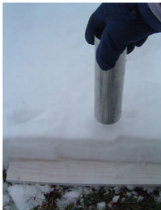
Fig. F.1.9.4.2.1- Modalità di prelevamento del campione per la misura della densità di uno strato di neve secondo la tecnica del carotaggio verticale; in questo caso si tratta di uno strato di neve fresca per cui il limite inferiore dello strato è dato dalla superficie della tavoletta da neve impiegata per la misura dell'altezza della neve fresca (vedi paragrafo F.1.8.4.1).
