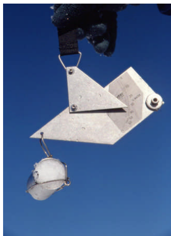
Fig. F.1.9.4.1.2- Kit per la misura della densità della neve completo di carotatore e bilancino.
