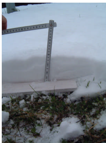
Fig. F.1.8.4.1.1- Modalità di misura dell'altezza della neve fresca; in questo caso la tavoletta era appoggiata sul terreno trattandosi di una nevicata su terreno privo di copertura nevosa.
