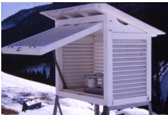
Fig. F.2.2.3.1.1 – Capannina meteorologica con termografo.
