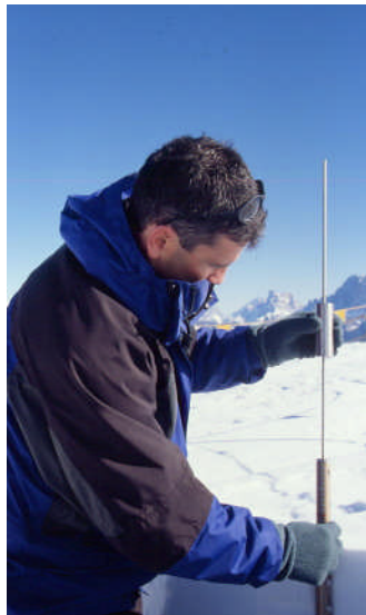
Fig. F.1.14.4.1.2 – Tecnica di impiego della sonda a percussione: la massa battente viene rilasciata da una certa altezza sull'asta guida provocando un affondamento della sonda nel manto nevoso.
