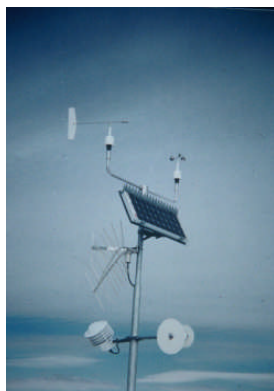
Fig. F.2.3.4.2.1 – Le stazioni nivometeorologiche automatiche richiedono frequenti interventi di manutenzione correttiva per guasti o rotture; nella fotografia sono evidenti i danni prodotti da un forte vento su albedometro e termoigrometro.
