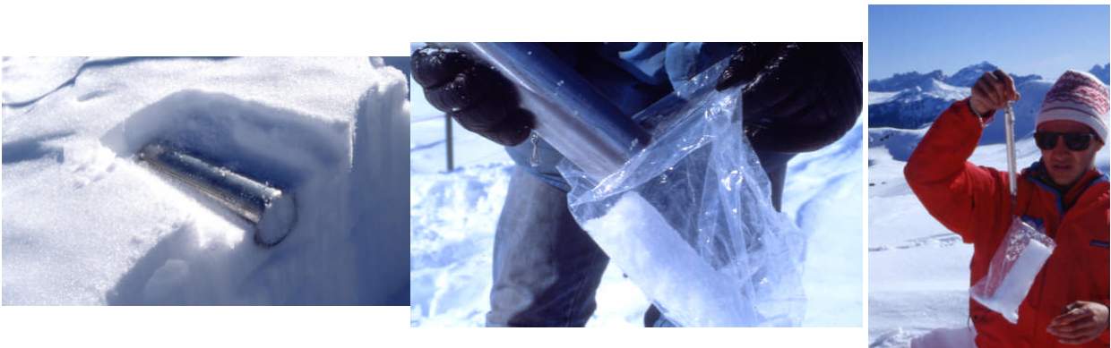
Fig. F.1.9.4.1.1- Modalità di effettuazione del carotaggio orizzontale: a) il carotatore viene inserito orizzontalmente nello strato; b) dopo aver estratto il carotatore ed eliminato i residui di neve sporgente, il campione di neve viene versato nel sacchetto di nylon per alimenti; c) si effettua la pesata del campione con un dinamometro.
