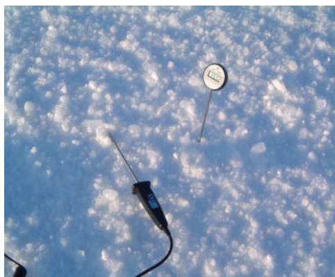
Fig. F.1.10.4.3.1 – Termometri utilizzati per la misura della temperatura della neve; sulla destra un termometro bimetallico, sulla sinistra la sonda di un termometro elettrico. Indipendentemente dal sistema di misura, l'elemento sensibile del termometro deve essere inserito in una sonda metallica sufficientemente robusta da consentire l'inserimento dello stesso anche nella neve ad elevata durezza.
