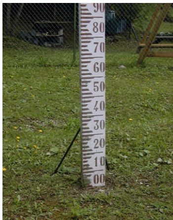
Fig. F.2.2.3.1 – Asta graduata fissa per la misura dell'altezza del manto nevoso.
