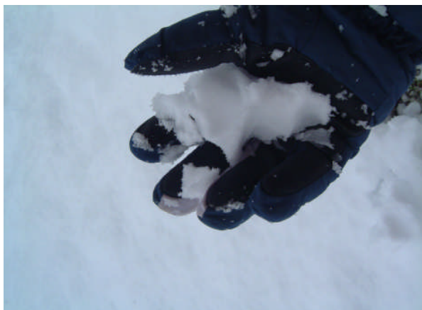
Fig. F.1.15.4.2.1 – Valutazione dell'umidità della neve con il metodo empirico: un campione di neve raccolto con mano guantata viene moderatamente strizzato per verificare la presenza di acqua allo stato liquido.
