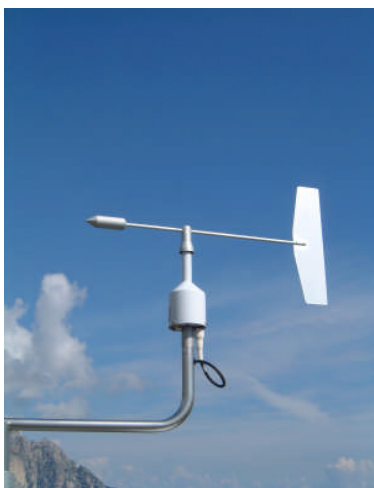
Fig. F.1.5.4.6.1- Sensore di direzione del vento a banderuola rotante.
