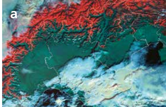
Fig. 7 - Serie di immagini MODIS riprese dal satellite Terra, elaborate da ARPAV-CVA in falsi colori e che riproducono la neve in tinta rossa (RGB 367).
