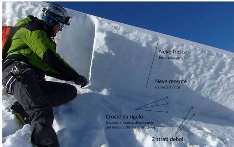
Fig. 5 - Valle d'Aosta, Courmayeur: stratigrafia del lastrone che ha travolto e ucciso 4 persone.
