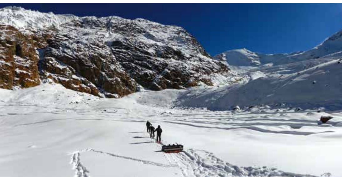
Fig. 6 e 7 - Strumentazione IDS STREAM X a 8 antenne a 200 MHz ed esecuzione rilievi.
