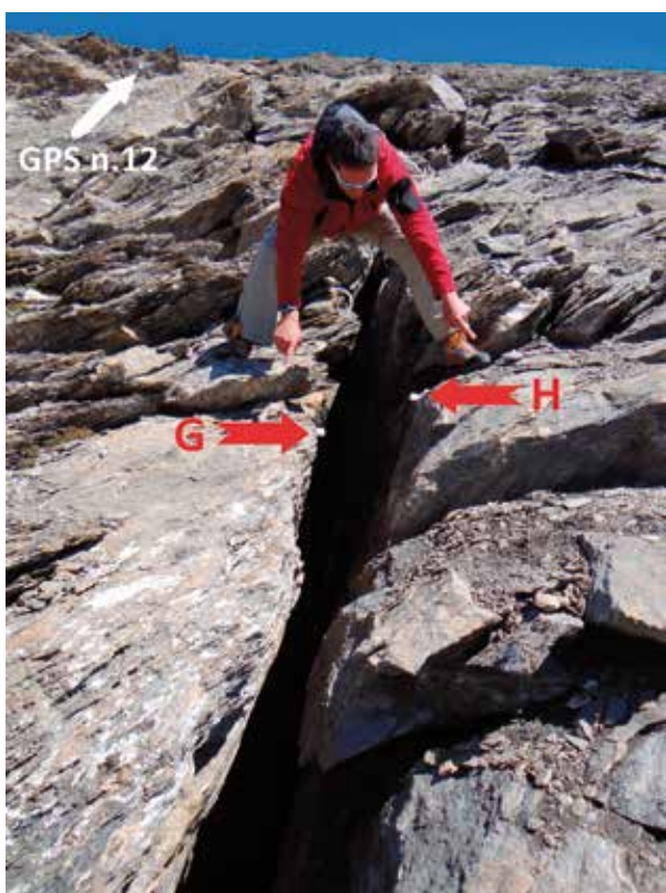
Fig. 12 - La base distanziometrica G-H nel luglio 2015 (capisaldi evidenziati dalle frecce rosse). Si noti l'abbassamento del margine sinistro (occidentale) della frattura (in origine, nel 2010, i capisaldi erano allineati orizzontalmente), lo stesso sul quale è installato il caposaldo GPS n.12 (identificabile grazie alla targhetta bianca in alto a sinistra indicata dalla freccia bianca).
