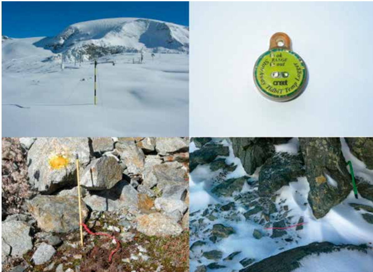
Fig. 3 - Rispettivamente in senso orario dall'alto a sinistra: Stazione meteo del Colle Superiore di Cime Bianche; data logger HOBO UTBI - 001; localizzazione (vista invernale) di un logger in condizioni di ridotto accumulo nevoso; localizzazione di un punto di misura nel periodo estivo.
