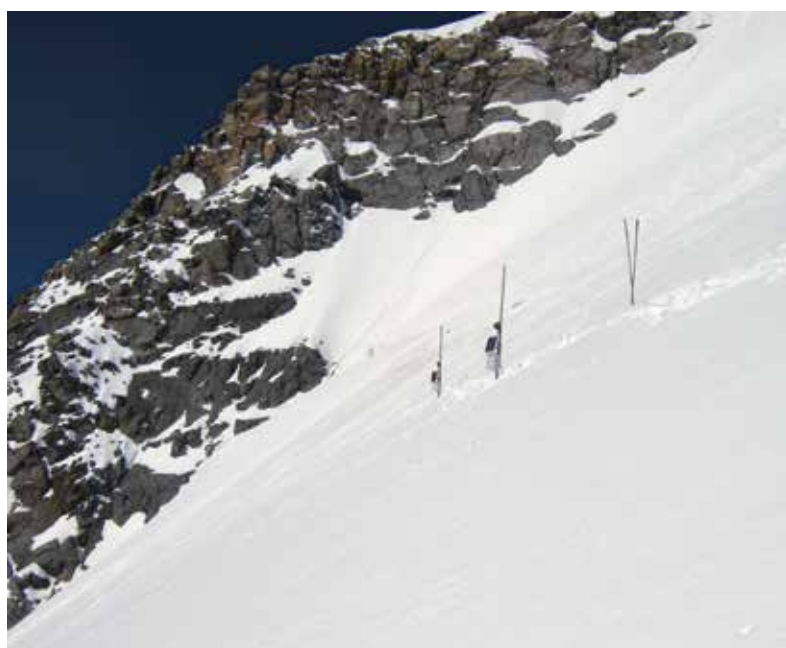
Sensori GNSS sulla superficie del Ghiacciaio delle Grandes Jorasses.
