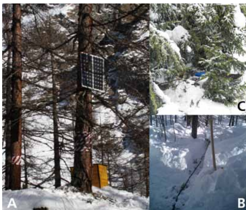
Fig. 2 - Installazione dell'array infrasonico: a) La stazione centrale di acquisizione dati è stata alimentata con 2 pannelli solari da 85 W. I sensori infrasonici, alloggiati all'interno di scatole coibentate (b), ed il cavo (c) sono installati sotto la neve.
