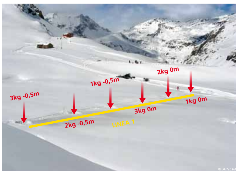
Fig. 5 - LINEA 1: schema di posizionamento cariche di Gelatina Dinamite in funzione dell'altezza di scoppio e della quantità di carica. Sono qui indicati i primi due set di tiri con un'altezza di scoppio di -0.5 m e 0 m (carica in manto e appoggiata). La sequenza delle detonazioni è controllata dall'altezza di scoppio e dalla quantità di carica.
