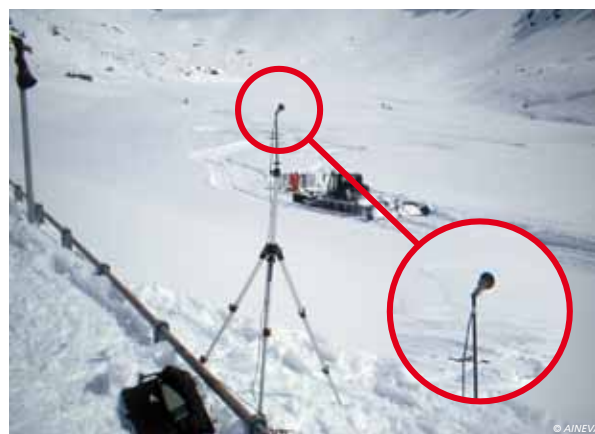
Dall'alto verso il basso, fig. 13 - Brillamento scoppio 5, realizzato mediante 2 kg di Gelatina Dinamite; andamento della registrazione vibrometrica secondo le tre componenti sismiche e quella acustica; fig. 14 - Principali caratteristiche dei fonometri utilizzati; fig. 15 - Stazione di monitoraggio acustica e particolare del microfono di acquisizione.
