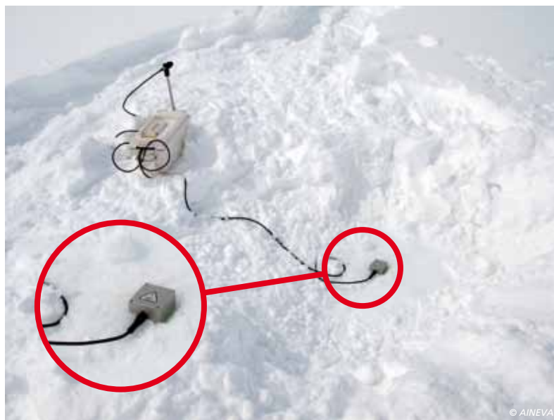
Fig. 12 - Stazione di monitoraggio e particolare del posizionamento di un geofono.
