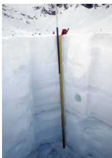
Fig. 6 - Profilo stratigrafico esterno alla linea di tiro.
