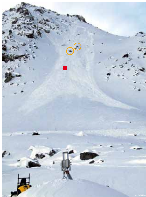
Fig. 9 - Visione frontale del sito: nei cerchi gialli sono evidenziate le due rocce che sono state spianate ed in rosso la posizione dell'ostacolo strumentato.
