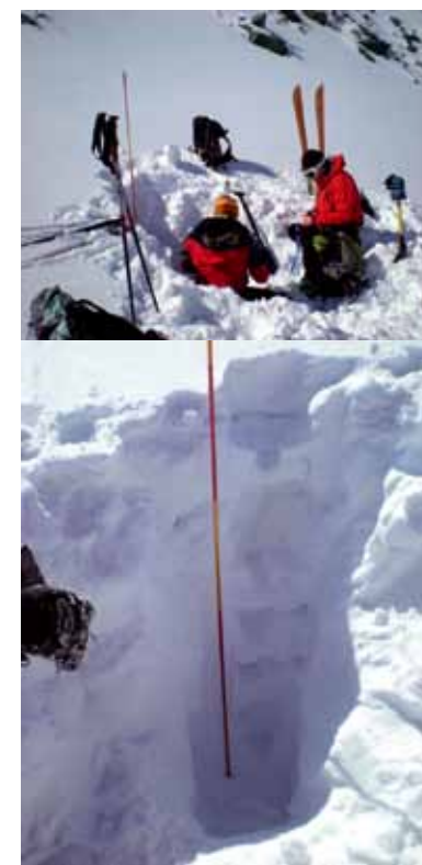
Fig. 2 - (a) Escavazione di trincea per rilievo della densità media del manto nevoso con tecnica classica. (b) Profilo verticale della trincea per la misura della densità media del manto nevoso. Sono visibili le impronte lasciate dal carotatore [Campagna rilievo 2009].
