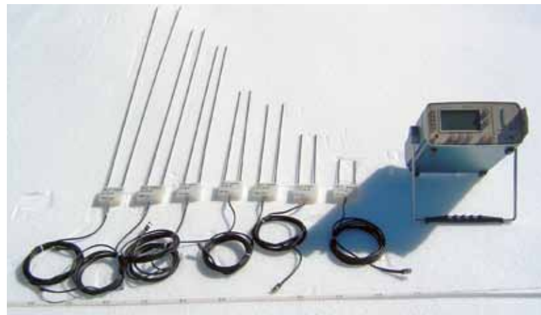
Fig. 7 - Strumentazione utilizzata nel rilievo: TDR cable tester TEKTRONIX 1502C e kit di sonde a due conduttori metallici paralleli di differente lunghezza.
