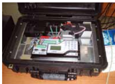
Fig. 12 - Sistema James, costituito da valigia compatta e impermeabile contenente batteria, acquisitore e collegabile tramite connettori stagni a 3 sonde WCR. Strumentazione DITAG - Politecnico di Torino.
