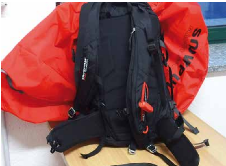
Fig. 5 - Zaino airbag danneggiato durante un travolgimento in valanga nella zona del Monte Bianco, discesa dei Marbrées. Cintura ventrale strappata e clip in plastica rotta: lo zaino è stato trovato più a valle e il travolto è stato completamente sepolto dalla valanga.
