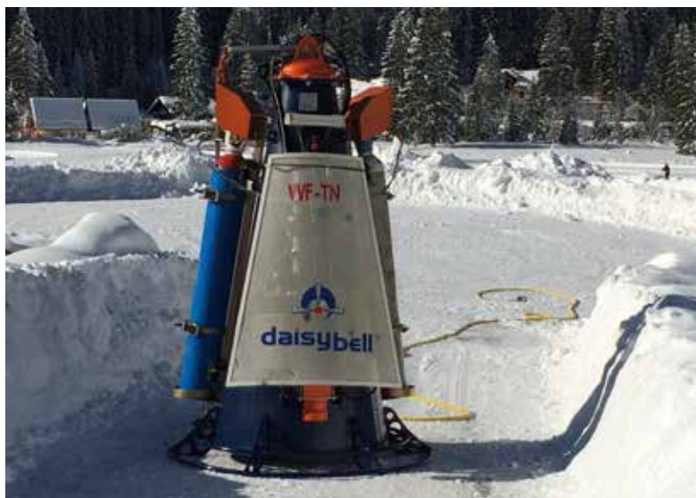
Fig. 20 - Dispositivo elitrasportabile per il distacco di valanghe "DaisyBell" della Provincia Autonoma di Trento.
