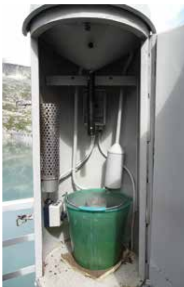
Fig. 3 - Pluviometro manuale di Pantano d'Avio (BS) posto all'interno di una cabina riscaldata SIAP. Si vedono: al centro il contenitore graduato che raccoglie la precipitazione all'interno di un secchio, a sinistra l'apparato riscaldante con il termostato impostato su 4 °C.
