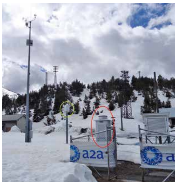
Fig. 7 - Stazione di Cancano dove sono affiancati un pluviografo elettronico riscaldato CAE PMB2 (cerchio verde) e un pluviografo meccanico riscaldato SIAP (cerchio rosso). Le misure di questi sono state confrontate con quelle manuali di SWE della neve fresca del vicino campo neve.
